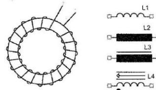
**14. El coeficiente de autoinducción de una bobina de 1.000 espiras que produce un flujo magnético de  $2 \cdot 10^{-4}$  Weber al ser recorrida por una corriente de 0,75 A es:**
